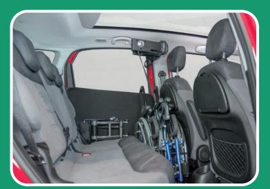
Por esto es necesaria también la instalación de la puerta corredera. Está disponible en dos versiones: la versión básica, en la que el movimiento de subida y bajada de la silla de ruedas se controla mediante un interruptor, y la versión deluxe, en la que el movimiento se controla mediante un panel de botones que, en caso de que se necesite, también controla la apertura y el cierre de la puerta eléctrica.
